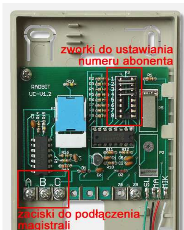
Wnętrze unifonu cyfrowego Radbit UCN
